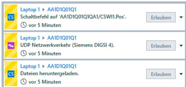
Abb. 6: Details für Abb. 5, neu angeschlossener unbekannter Laptop versucht, den Leistungsschalter unbefugt zu steuern
